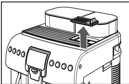
**i** Hinweis: Wird kein vorgemahlener Kaffee in das entsprechende Fach eingefüllt, erfolgt lediglich die Ausgabe von Wasser; Ist die eingefüllte Portion zu groß und werden 2 oder mehr Messlöffel Kaffee eingefüllt, gibt das Gerät kein Produkt aus. Auch in diesem Falle führt das Gerät einen Leerzyklus aus und wirft den Pulverkaffee in den Kaffeesatzbehälter aus.
