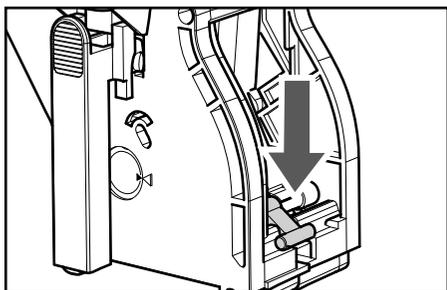
**10** Sicherstellen, dass sich der angegebene Haken für die Sperre der Brühgruppe in der korrekten Position befindet. Um dessen Position zu überprüfen, wird die Taste "PRESS" kräftig gedrückt wird.
