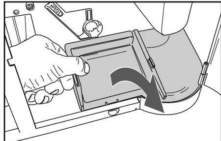
**7** Den internen Behälter herausnehmen, reinigen und wieder in die entsprechende Aufnahme einsetzen.
