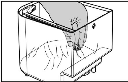
**12** Den Wasserfilter in den leeren Tank einsetzen. Bis zum Einrasten drücken.
