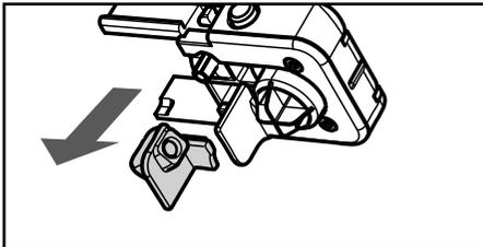
**14** Die Teile unter laufendem Wasser reinigen. Sicherstellen, dass eventuelle Ablagerungen/Verkrustungen der Milch entfernt wurden.
