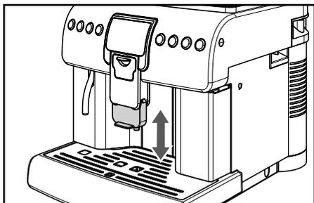
Für diese Einstellung wird der Auslauf von Hand nach oben oder nach unten geschoben.
