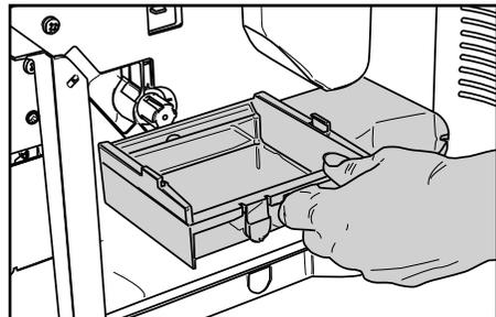
**i** Hinweis: Wenn der Behälter eingesetzt wird, ist die Vorgehensweise zur Herausnahme in umgekehrter Reihenfolge auszuführen.
