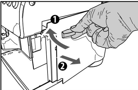
**4** Die Brühgruppe herausnehmen, indem sie am entsprechenden Griff gehalten und die Taste «PRESS» gedrückt wird. Die Brühgruppe darf ausschließlich mit lauwarmem Wasser ohne Reinigungsmittel gereinigt werden.
