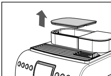
**2** Den Tank entfernen, indem er am im Inneren angebrachten Handgriff angehoben wird.
