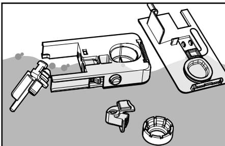
**15** Nach der Reinigung alle Bestandteile wieder in umgekehrter Reihenfolge montieren.
