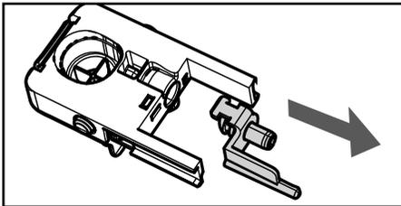
**13** Den Anschluss des Ansaugschlauchs aus dem Cappuccinatore entfernen.
