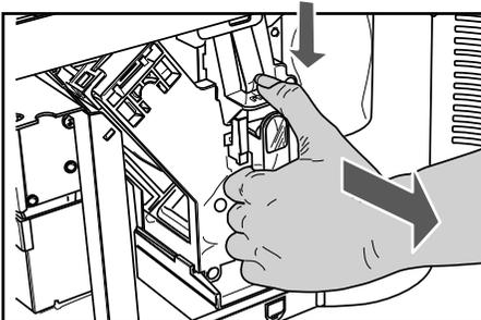
**5** Die Brühgruppe mit lauwarmem Wasser reinigen. Den oberen Filter sorgfältig reinigen. Bevor die Brühgruppe in ihre Aufnahme eingesetzt wird, ist sicherzustellen, dass kein Wasser in der Brühkammer verblieben ist.
