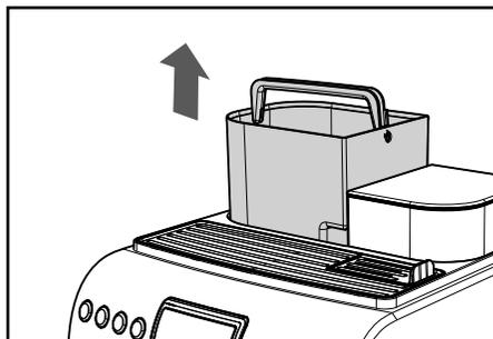
**3** Den Tank ausspülen und mit frischem Wasser füllen. Der Füllstand (MAX), der im Tank markiert ist, sollte nicht überschritten werden.
