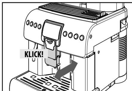
**i** Sicherstellen, dass der Auslauf korrekt positioniert wurde. Er wird horizontal verschoben, bis der KLICK zu hören ist, mit dem die korrekte Positionierung angezeigt wird. Im gegenteiligen Falle ist der Austritt des Produktes aus dem äußeren Bereich des Auslaufs möglich.
