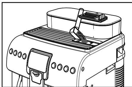
**!** Achtung: Ausschließlich vorgemahlene Kaffee in das Fach füllen. Die Einfüllung anderer Substanzen und Gegenstände kann zu schweren Schäden am Gerät führen, die nicht durch die Garantie gedeckt sind.
